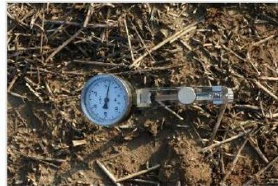
Abbildung 24: Messung der Bodenwasserspannung mittels Tensiometer (© Schnittstelle Boden)
